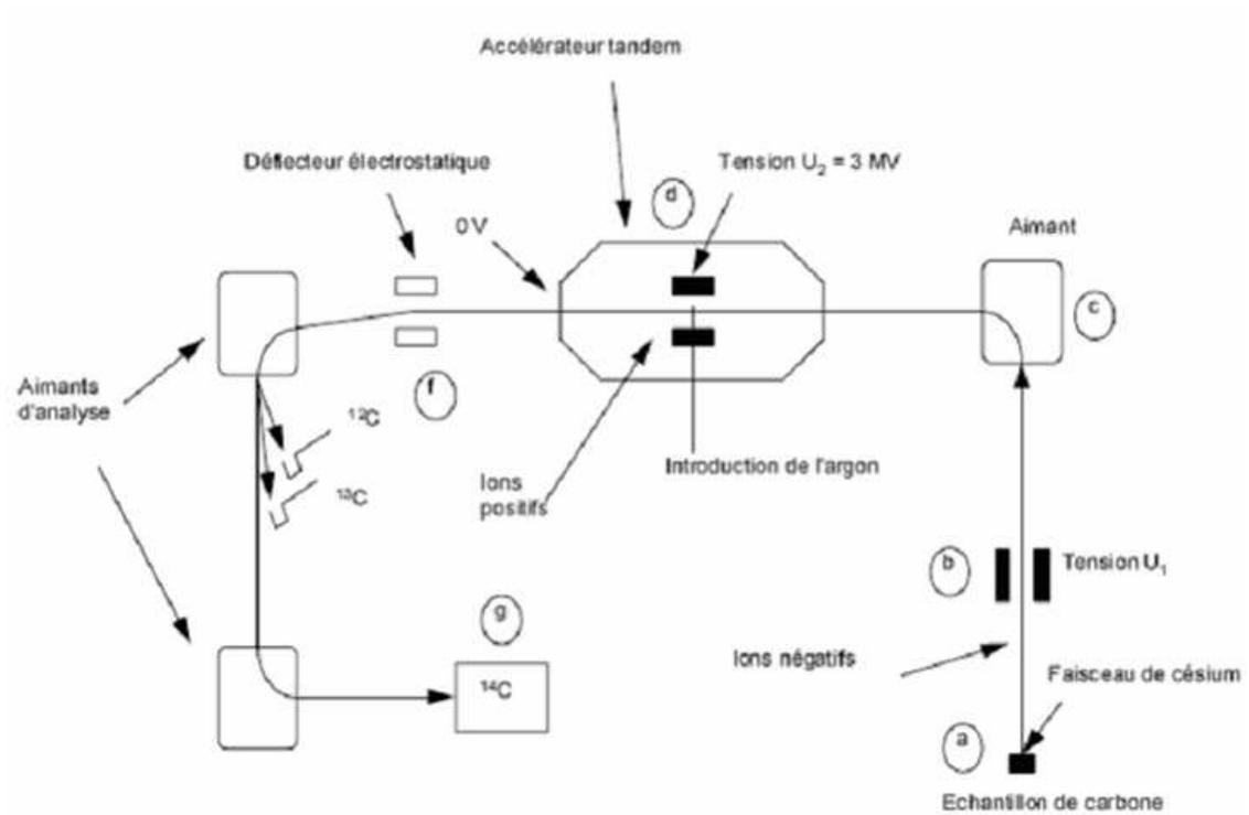
Figure 7 : Représentation simplifiée d'un spectromètre de masse utilisant un accélérateur tandem.
