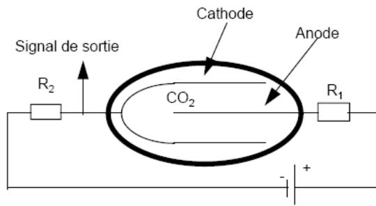
Figure 5 : Schéma de principe d'un compteur à gaz
