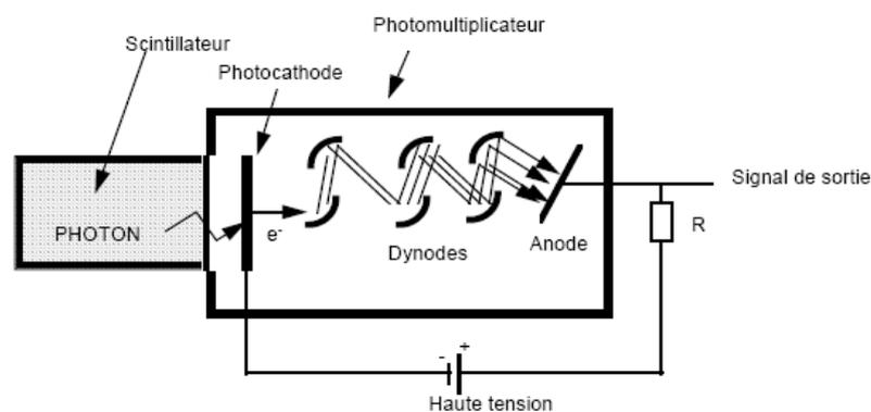
Figure 6 : Schéma de principe d'un détecteur à scintillation
