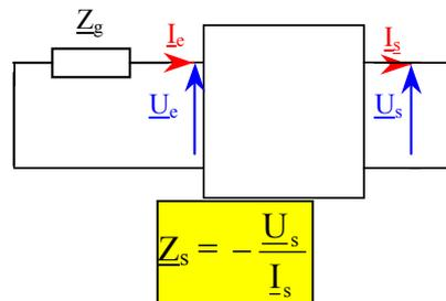
C'est l'impédance vue de la sortie du quadripôle avec les sources indépendantes éteintes. Attention au fléchage de  $\underline{I}_s$  ! S'il est dans l'autre sens, il n'y a plus le signe -.
