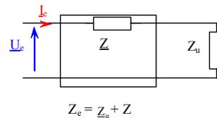
Rem. : Certains quadripôles ont une impédance d'entrée constante (pour les AOP LM741  $Z_e = 1 \text{ M}\Omega$ , pour le TL081  $Z_e = 10^{12} \Omega$ )
