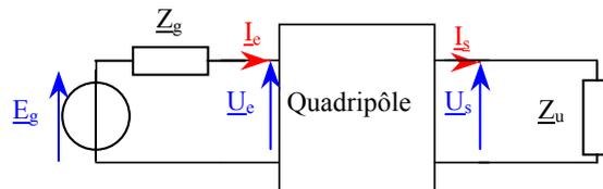
Un quadripôle est dit linéaire s'il n'induit pas de distorsion ou de déformation du signal de sortie par rapport au signal d'entrée. Le signal de sortie doit donc avoir la même forme que le signal d'entrée.
