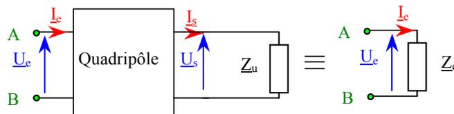
Déf. : On appelle impédance d'entrée, l'impédance que verrait un montage branché en entrée du quadripôle. Elle dépend de la charge  $Z_u$ . On peut donc dire que vu depuis AB l'impédance d'entrée remplace le quadripôle et la charge.
