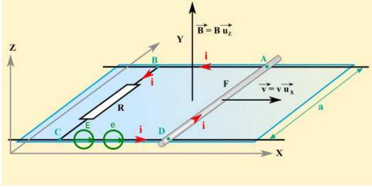
Soit une tige de résistance  $R$ , de masse  $m$ , de vitesse  $\vec{v}$  se déplaçant sur des rails conducteurs distants de  $a$  dans un champ  $\vec{B} = B\vec{e}_z$ .
