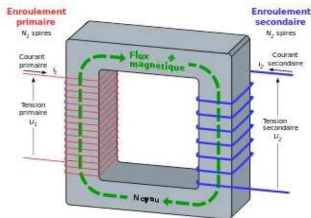
Dans un transformateur réel, pour gagner en rendement, les lignes de champ magnétique sont canalisées par un noyau de fer.
