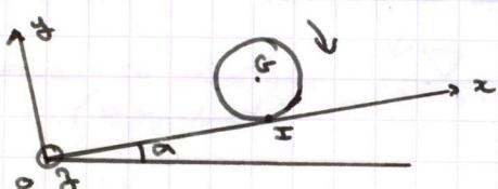
Soit une roue de rayon  $r_m$ , de masse  $m$  mise en mouvement par un couple moteur  $M \vec{e}_z$  afin de lui faire remonter la pente.
