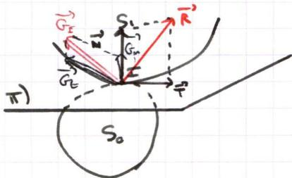
On va modéliser les actions de contact qui exercent  $S_0$  sur  $S_1$ , en considérant que la surface de  $S_0$  en contact avec  $S_1$ , subit un ensemble de forces auquel on associe un torseur dit torseur des actions de contact.
