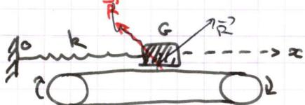
Soit une masse  $m$  au repos sur un tapis roulant défilant à la vitesse  $v$  par rapport au sol. La masse est reliée à un pt fixe  $O$  par un ressort de raideur  $k$  et de longueur  $x_0$ .
