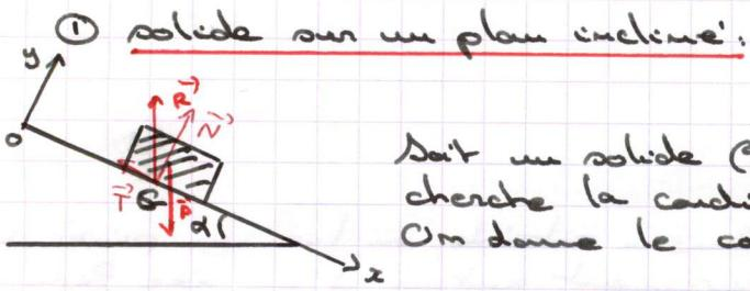
Soit un solide (S) posé sur un plan incliné. On cherche la condition d'équilibre de ce solide. On donne le coefficient de frottement statique  $f_s$ .
