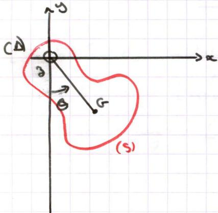
Soit un solide de masse m, de moment d'inertie J par rapport à A.
