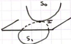
Sont 2 solides en contact au pt I. Les actions de contact sont représentées par le couple  $[R̄, M̄_I]$ .
