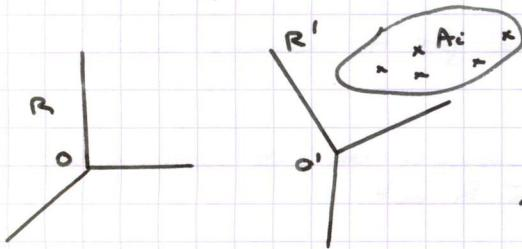
$$P'_{int} = \sum_{ij} \vec{F}_{i\leftarrow j} \cdot \vec{s}'_i \quad \text{on } \vec{s}'_i = \vec{s}_i + \vec{\omega}' \wedge \vec{r}_{Ai}$$
