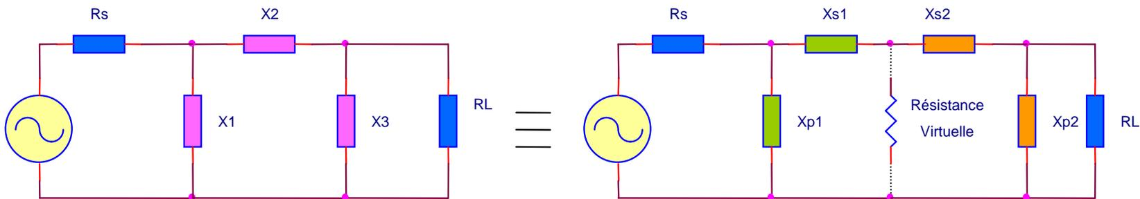
Le réseau en  $\Pi$  peut être décomposé en deux réseaux en L montés en cascade et procurant une adaptation à une résistance virtuelle  $R_V$  située entre les deux.
